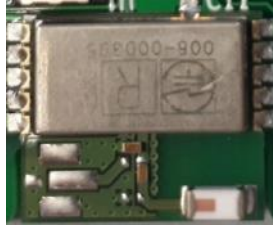
Modulo Bluetooth Low Energy montato sulla STEVAL-FCU001V1
