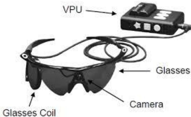
L'apparecchiatura esterna comprende gli occhiali, un'unità di elaborazione video (VPU) ed un cavo.
