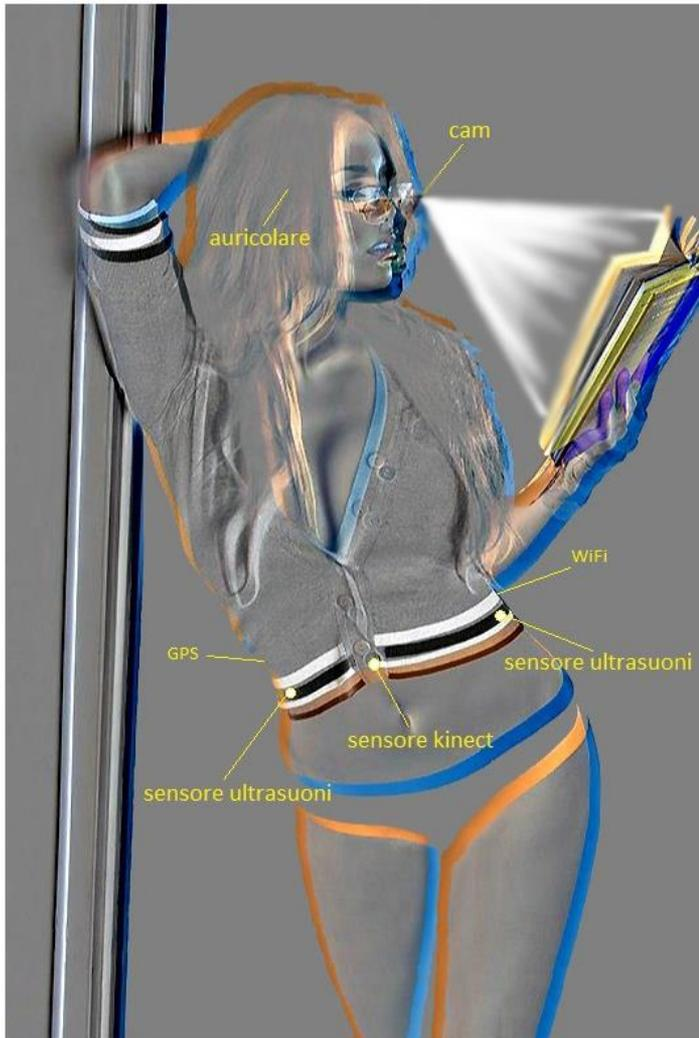
Tra le soluzioni progettate ed in via di realizzazione, vi è la piattaforma indossabile vEyes Wear, ovvero un sistema modulare indossabile, basato su di una **cintura** munita dell'elettronica di un device Android, di una depth camera e di microcontroller Arduino ed un paio di **occhiali** muniti di cam WiFi fullHD, sensori vibro ed auricolare a conduzione ossea.
