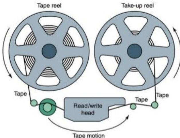
I nastri magnetici, oggi, vengono utilizzati esclusivamente come unità di *backup* per data center, in virtù della loro enorme capacità di memorizzazione ed al basso costo.
