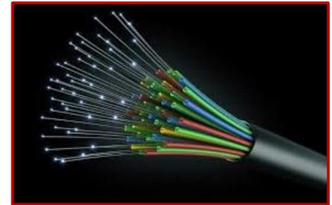
Un emettitore di laser invia il segnale luminoso. All'altra estremità è presente un ricevitore che converte il segnale da luminoso in elettrico. Se l'angolo incidente con il quale il laser colpisce l'esterno della fibra è inferiore ad un certo valore, si ha la riflessione interna totale (assenza di rifrazione):
