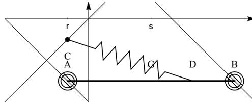
4. Per determinare le reazioni vincolari si devono impostare le due equazioni cardinali, conviene usare  $A$  o  $B$ , si sa che la reazione vincolare in  $A$  è  $\vec{\Phi}_A = (\varphi, \varphi)$ , mentre quella in  $B$  è  $\vec{\Phi}_B = (\psi, \psi)$ . Si ha che
