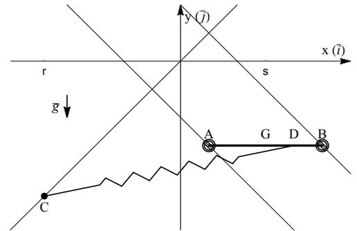
Tra il punto materiale  $C$  ed un punto  $D$  dell'asta posto lungo l'asta a distanza  $1/2\ell$  da  $B$  ed a distanza  $3/2\ell$  da  $A$  è fissata una molla di costante elastica  $mg/\ell$ . Sul sistema agisce la gravità. Usando come coordinate lagrangiane  $s$  la coordinata  $x$  di  $G$  ed  $r$  la coordinata  $x$  di  $C$ , ovvero  $s = OG \cdot \vec{i}$ ,  $r = OC \cdot \vec{i}$ .
