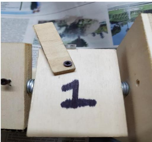
Le asticine di legno sono state fissate con una vite per legno, senza avvitare fino in fondo la vite, così da poterne lasciare fluida la rotazione
