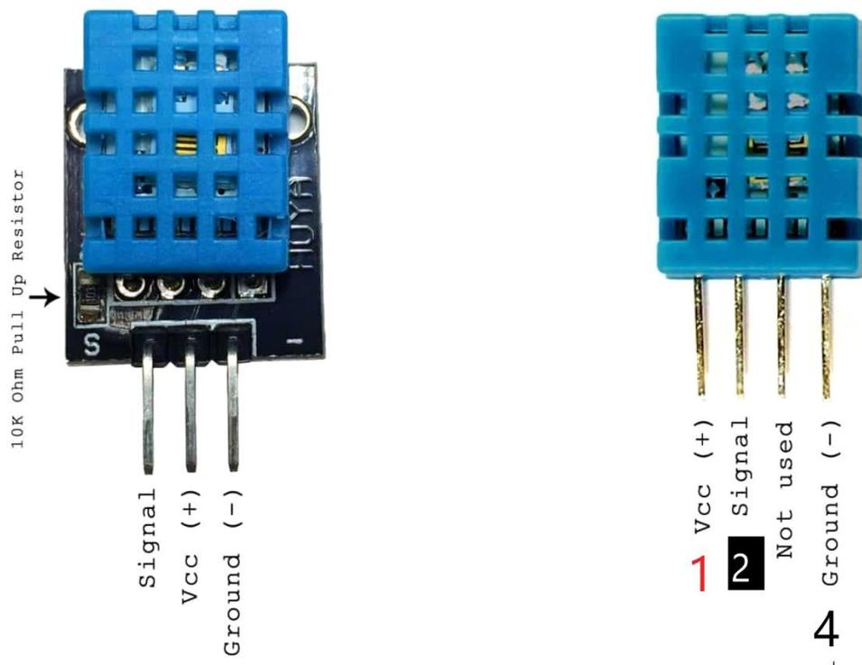
Se si dispone di un DHT11 a quattro pin e si desidera trasmettere umidità e temperatura al nostro Raspberry PI bisogna collegarlo in questo modo:
