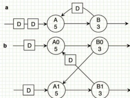
Schaumont, Figure 2.23 - unfolding: (a) grafo originale (b) grafo dopo 2-unfolding
