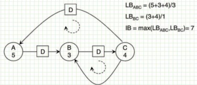
Schaumont, Figure 2.17 - Calcolo di limiti di maglia e d'iterazione
