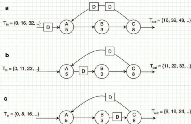
Schaumont, Figure 2.21 - Retiming: (a) grafo originale. (b) grafo dopo la prima trasformazione di re-timing. (c) grafo dopo la seconda trasformazione di re-timing
