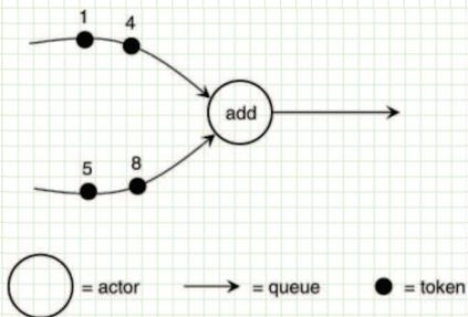
Schaumont, Figure 2.3 - modello dataflow di un'addizione
