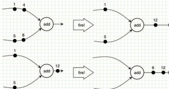
Schaumont, Figure 2.4 - risultato di due attivazioni dell'attore add, ciascuna produce un marking diverso
