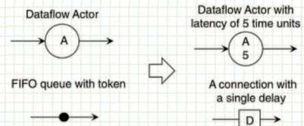
Schaumont, Figure 2.15 - Estensione del modello SDF con risorse: latenza di attori, buffer per code FIFO
