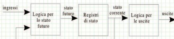
Uscite in funzione dello stato corrente (FSM di Moore)
