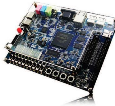
Scheda di sviluppo Altera DE1-SoC con FPGA Cyclone V
