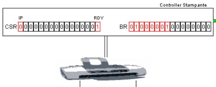
preleva il carattere in testa all'output buffer e lo mette in BR (nella figura sopra ha prelevato il carattere 'A', codice ASCII 65);
