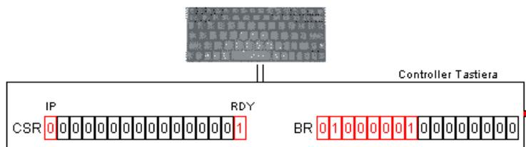
Ovviamente è possibile che in precedenza un tasto sia stato premuto e che ancora la gestione dell'interruzione relativa non sia terminata. È possibile cioè che il controller, quando si preme un tasto, trovi ad uno il bit RDY. In questo caso possiamo supporre che quel che viene fatto sia semplicemente di inserire nei bit 13-1 del CSR un codice di errore
