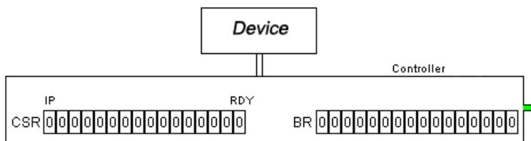
Quando un device necessita di "attenzione" da parte della CPU (vuoi per segnalare semplicemente un evento, vuoi perché desidera che la CPU svolga per conto del device alcune operazioni) questo pone ad uno il bit 15 del suo CSR (detto IP, Interrupt Pending), fa richiesta cioè di un'interruzione. L'hardware copierà il bit IP in OPC
