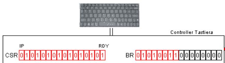
Dopo aver fatto quanto specificato sopra, il driver controllerà se nei bit 13-1 del CSR sia presente un codice di errore. A questo punto il driver può porre a 0 il bit RDY del CSR (indicando così che il carattere è stato prelevato), abilitare nuovamente le interruzioni e ritornare dall'interruzione. Ricordiamo che, trattandosi di memory-mapped I/O, le operazioni sui registri vengono effettuate come normali letture/scritture in memoria.
