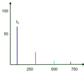
Il segnale è una somma di sinusoidi di frequenza multiple intere della frequenza del segnale ( $f_0$ ).
